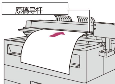
将原稿导杆向右拨动，可以移动原稿的扫描位置。
