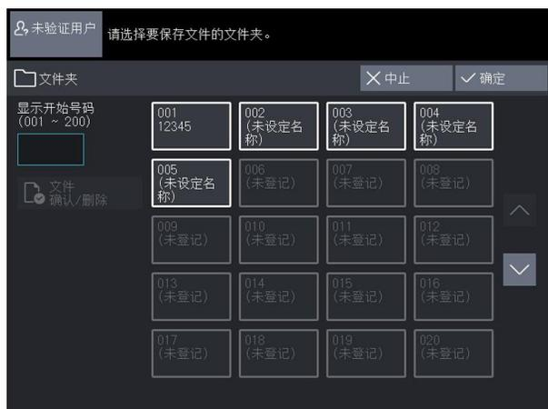
**补充** · 想将某一文件夹显示到前端时,请在 [ 显示开始号码 ] 中输入文件夹的编号。
